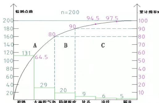
3. (1) 返锈、大面积气泡做返工处理; 局部脱皮、针孔、流挂、漏涂做返修处理。
