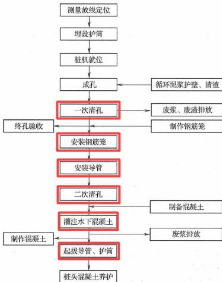
图 4.1.11 泥浆护壁成孔灌注桩施工流程
