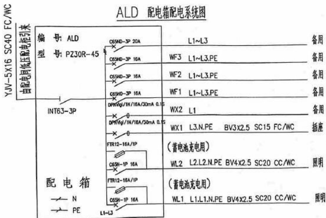
图6. II. 3 配电箱系统接线图、设备材料表
